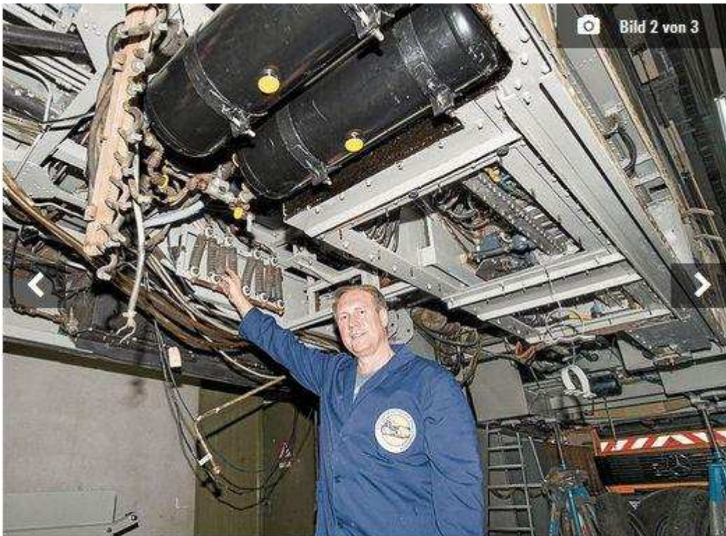
Ronald Kiebler unter dem Bus, vorne sind zwei von sechs Druckluftbehältern des Busses zu sehen. Kieblers Hand zeigt auf die Shuntwiderstände.
